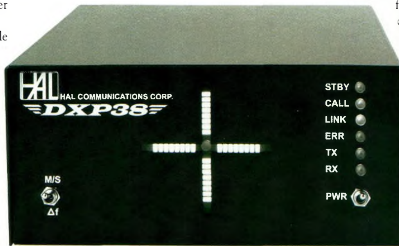
Le modem HF DSP DXP38 de HAL Communications permet un trafic de grande qualité dans les principaux modes digitaux. Il suffit de le connecter entre votre transceiver et votre ordinateur. Le logiciel est inclus. (Photo HAL Communications)
