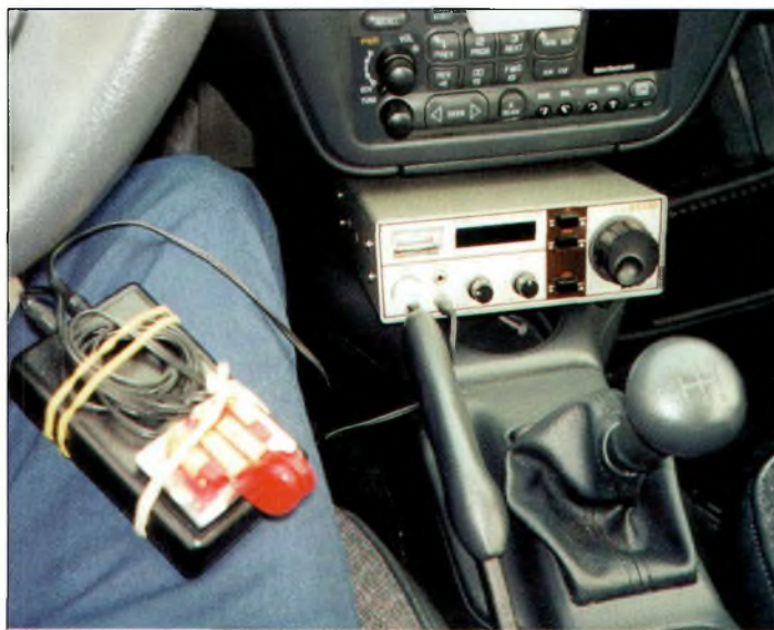
Photo B- Un transceiver HF mobile peut se loger un peu partout dans l'habitacle. Avec des appareils comme les IC-706MKIIG, DX-70 et autres FT-100, le choix de l'emplacement n'est plus un problème. Pour la CW, un manipulateur à genouillère peut être utilisé.
