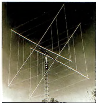
La Quad Cubex MKII a deux éléments et fonctionne sur trois bandes. Les éléments pour les trois bandes sont imbriqués les uns dans les autres.
