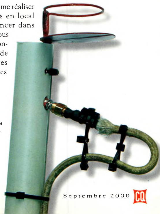
Fig. 9-Le câble coaxial pour la partie 1,2 GHz doit être de la meilleure qualité possible. Évitez si possible les petits câbles Téflon de 2 ou 3 mm de diamètre.
