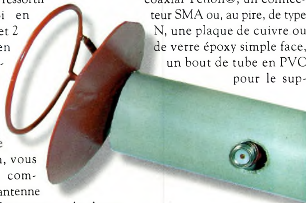
Fig. 7-Le support en tube PVC de 20/22.
