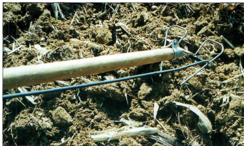
On scrute le sol avec une antenne 1,2 GHz installée au bout d'un manche à balai. C'est un peu le même principe que le détecteur à métaux, mais sur des fréquences beaucoup plus hautes !
