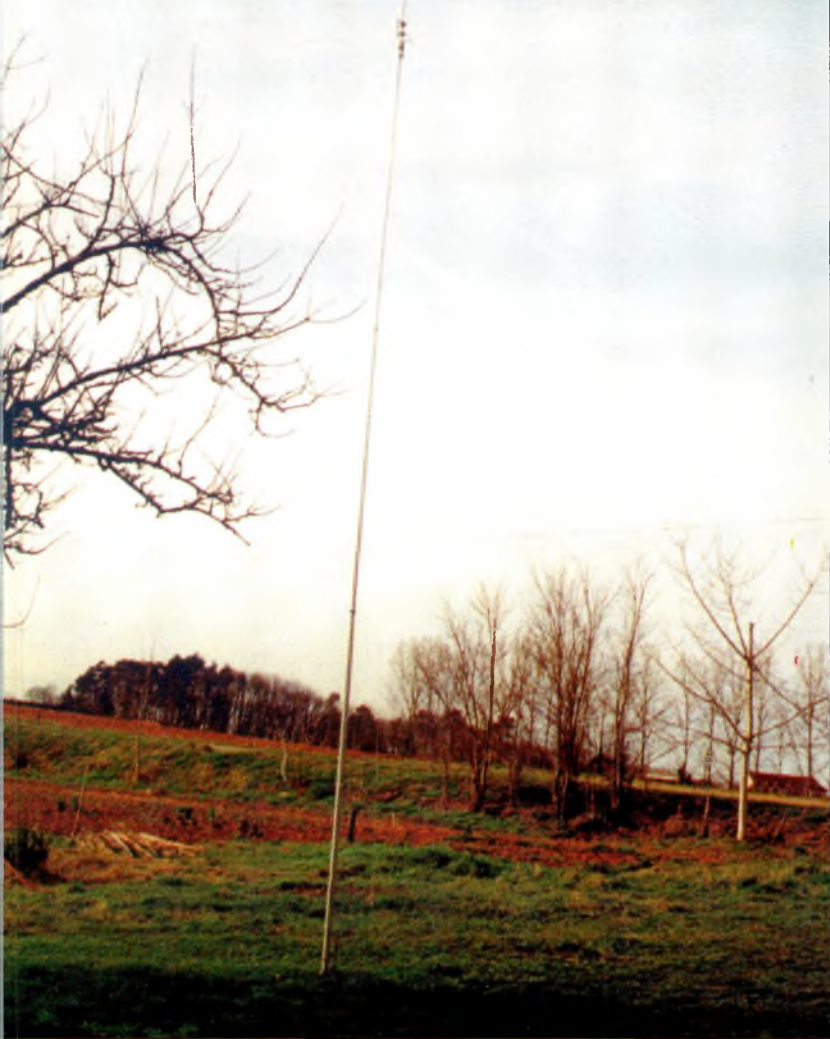
La verticale quart d'onde sur 40 mètres réalisée à partir de matériaux de récupération. Lorsque la beam sera réparée, le boom qui a servi à la construction de cette antenne reprendra son service normal.
