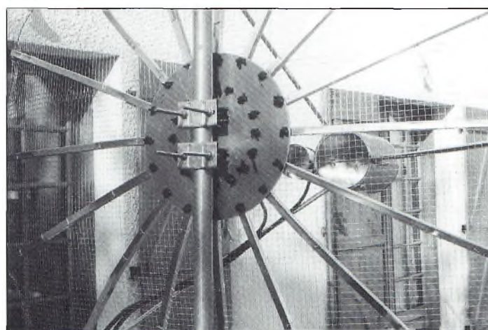
Vue arrière de l'antenne. Les vis ont reçu une touche de peinture pour les bloquer et les empêcher de rouiller.
