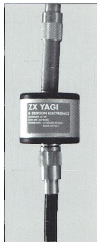
Dans sa version ronde, le MTFT est ici modifié pour permettre la connexion d'un fouet verticale destiné au mobile.
