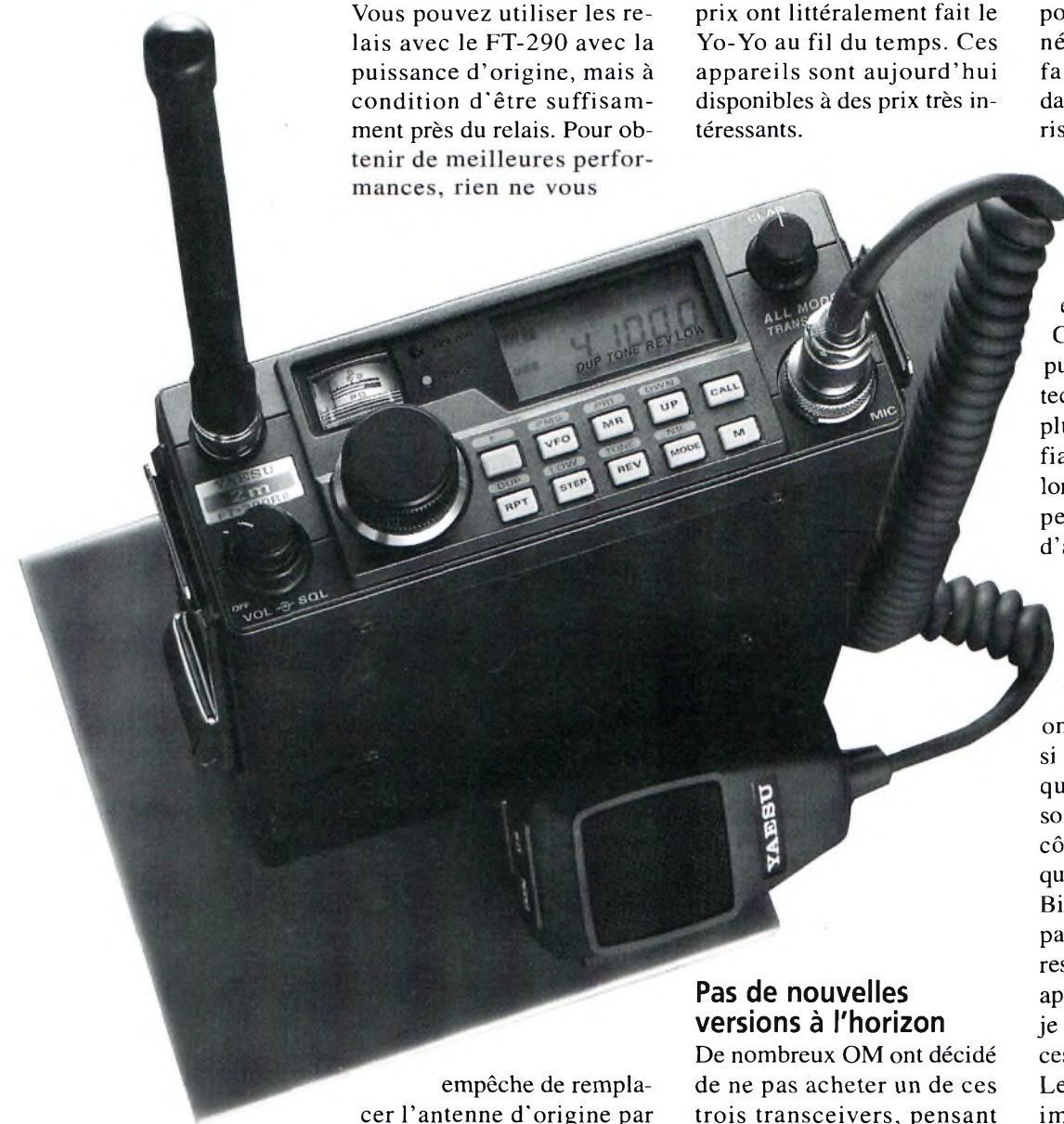
Le FT-290R II, l'un des transceivers VHF les plus populaires au monde.
