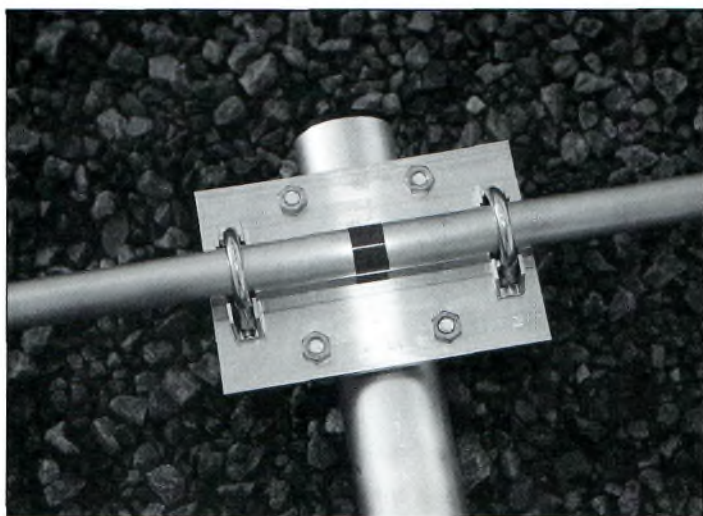
Chaque élément est solidement fixé grâce à une plaque et quatre colliers.
