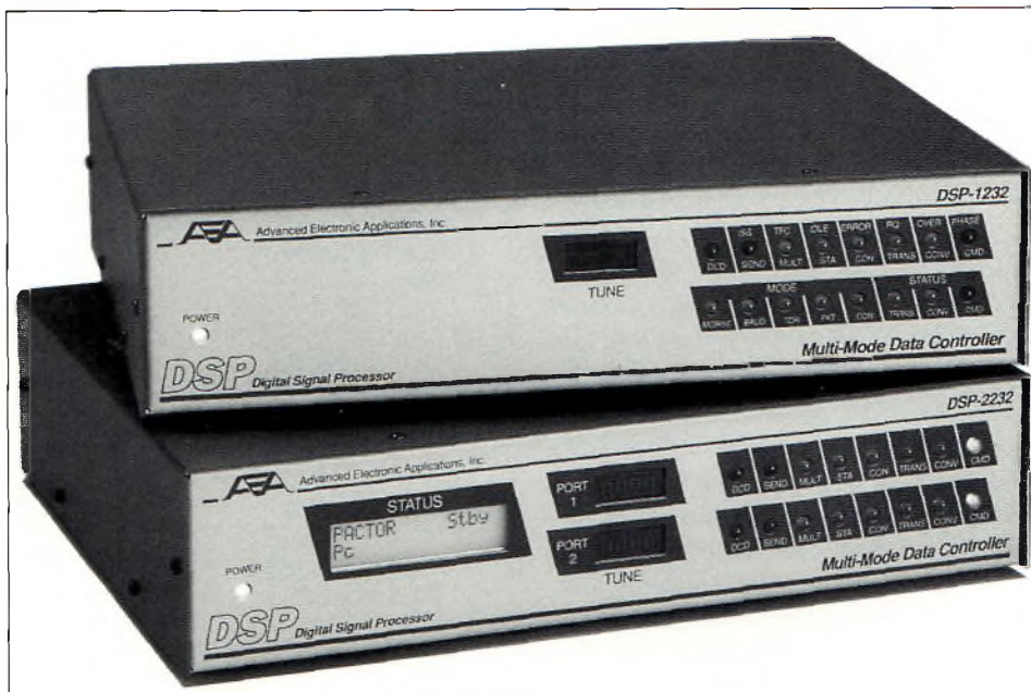
Un TNC multimodes accompagné d'un bon logiciel suffit pour pratiquer le RTTY.
