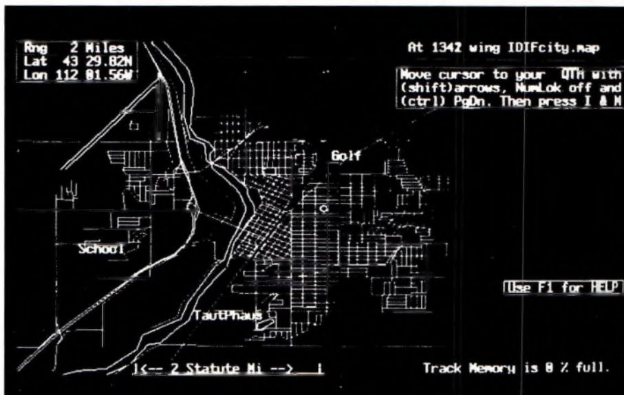
Photo D - Extrait d'une carte APRS incluse dans les PK-12 et PK-96.
