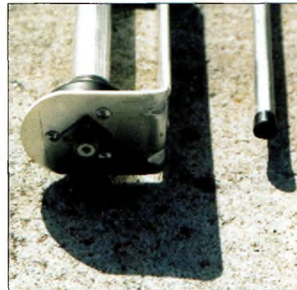
Une fiche SO-239 assure la liaison avec le câble coaxial.
