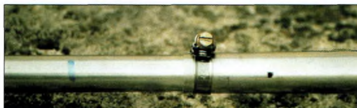
Un trait « usine » permet d'ajuster chaque brin du fouet quart d'onde sur 28 MHz.
