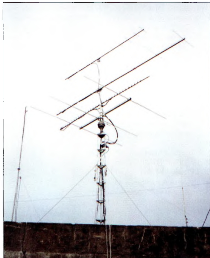
Les antennes VHF du haut vers le bas. 432, 144, 1 200 et 50 MHz.
