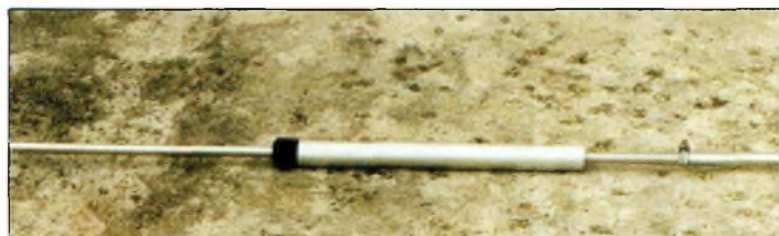
La trappe permettant un fonctionnement sur les bandes 15 et 20 mètres.
