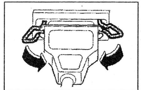
**FIG. 2 - Conexão Centronics do cabo (ligar à impressora).**
