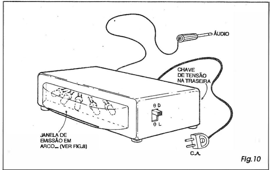
janela, o hemi-cilindro baixo poderá também ser feito de material opaco, plástico, efetuando-se ao longo da sua borda vertical em arco os 5 furos necessários à passagem das *cabeças* ativas dos LEDs (que devem, então, sobressair dos ditos furos, para que a emissão se dê sem problemas...). Mecanicamente, a coisa dará um pouquinho de trabalho, mas com capricho, atenção e criatividade, sabemos que o leitor/hobbysta conseguirá um resultado final bonito e funcional...!
