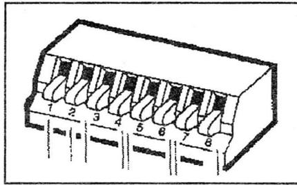
FIG. 3 - Micro-switches de configuração da impressora.
