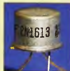
Obr. 2. NPN tranzistor typu 2N1613, výrobek Fairchild (1963)
