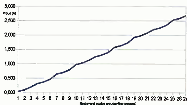
Obr. 3. Nastavování omezení výstupního proudu ve 27 krocích
