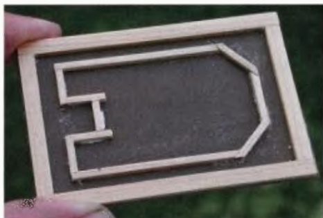
Obr. 2. Větší forma z dřevěných lišt na kuprextitu
