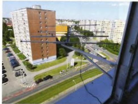
Obr. 1 a 2. Celkový pohled na anténu i s držákem na okenním rámu
