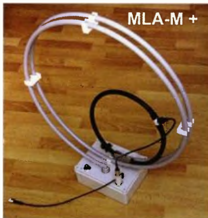
Obr. 19. Anténa MLA-M+ s Faradayovou budič smyčkou
