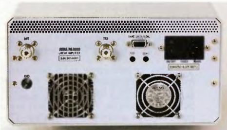
Obr. 2. Zadní panel JUMA PA1000
