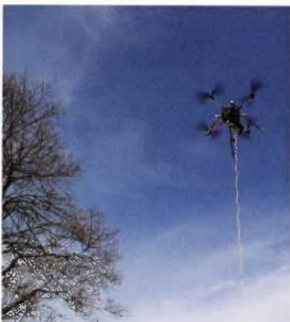
Obr. 5 a 6. Pomocná (směrová) šňůra přes koruny stromů
