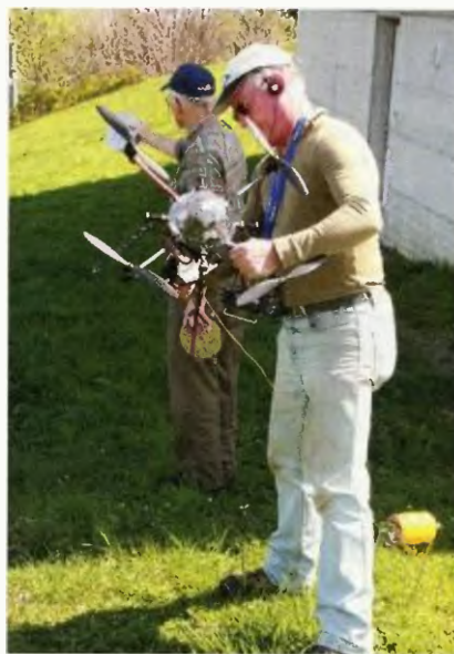
Obr. 2. Příprava kvadrokoptéry. Na odvíjecím stojánku na zemi směrová šňůra
