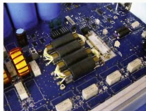
Obr. 3. Část desky s výkonovým zesilovačem a výstupním vf transformátorem
