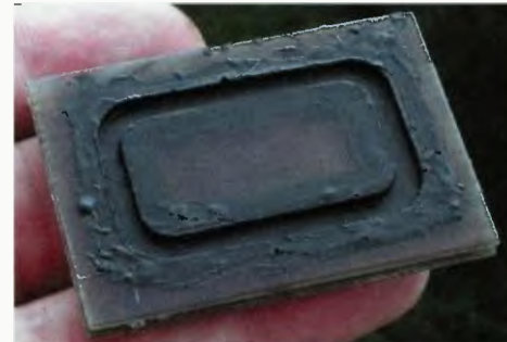
Obr. 4. Nanosená vrstva asfaltového separátoru
