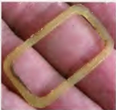
Obr. 6. Očištěné těsnění před finálním zbavením otřepků
