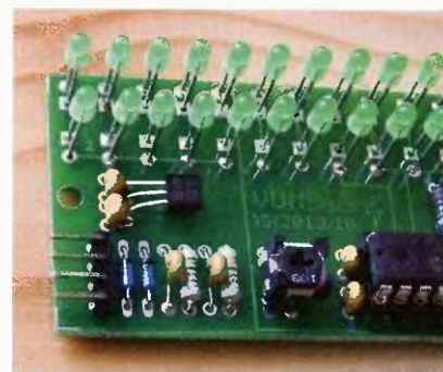
Obr. 2 až 4. Deska s plošnými spoji v měřítku 1:1 (rozměr desky 82 x 36 mm) a rozmístění součástek
