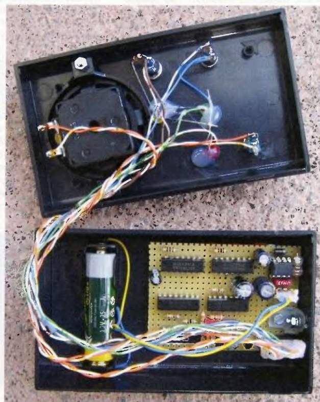
Obr. 2 Osadená doska kocky a jej umiestnenie v krabíčke
