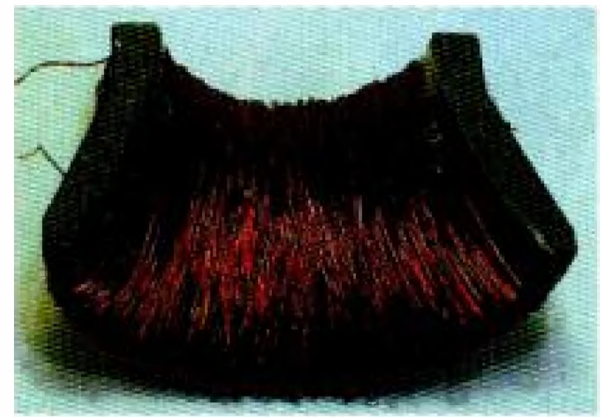
Obr. 2. Aplikační cívka na feritovém jádru z vychylovací cívky z televizoru
