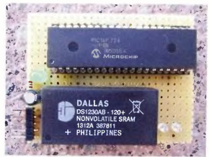
Obr. 22. Pripojenie NVRAM DS1230AB na zbernici I 2 C s obvodom podľa zapojenia na obr. 21
