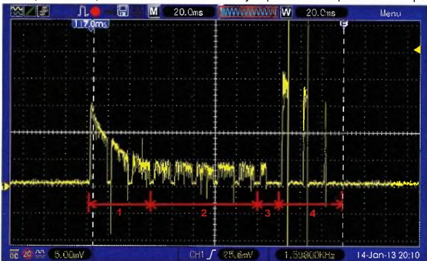
Obr. 18. Průběh proudu servem (10 mV odpovídá 1 A): 1. rozjezd, počáteční proud klesá; 2. přejezd stálou rychlostí bez zatížení; 3. regulátor ubírá, blíží se cílová poloha; 4. brzdění v cíli, největší odběr
