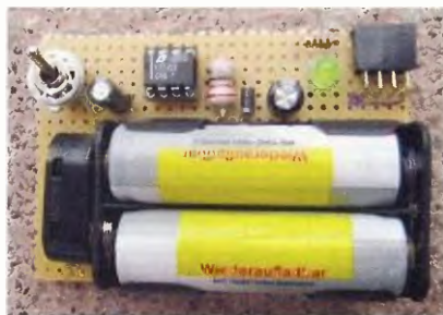
Obr. 2. Menič s LT1303-5 na univerzálnej doske
