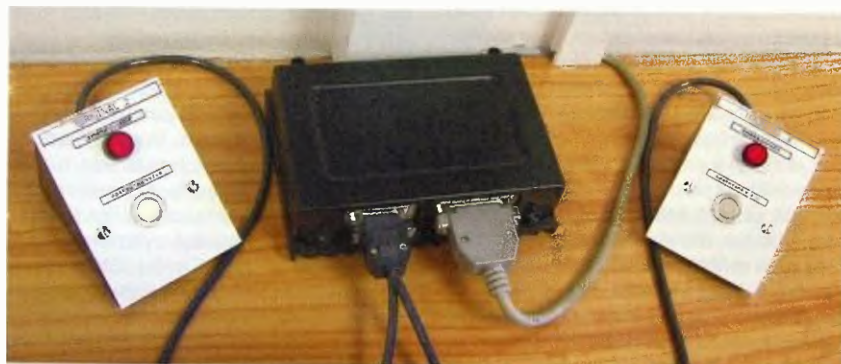
Obr. 11. Čierna skrinka v strede je riadiaci modul (modul RM) a po jeho stranách sú dva moduly obsluhy terminálu (MOT)
