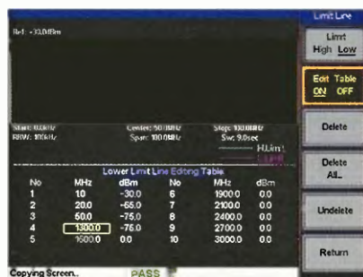
Obr. 5. Funkce pass/fail a omezující křivka zadaná tabulkou
