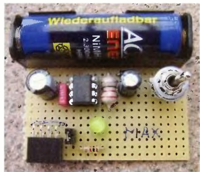
Obr. 5. Fotografia realizovaného meniča s MAX756
