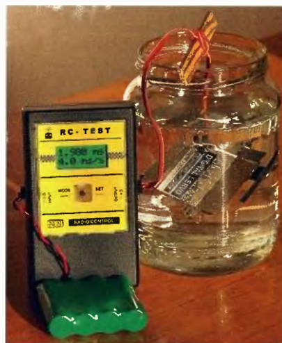
Obr. 17. Zkoušky těsného serva při ponoření pod hladinu
