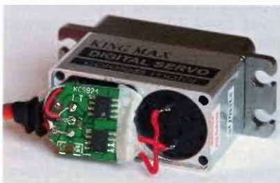
Obr. 16. Celokovový kryt serva King Max a současně vada servozesilovače - odizolované vodiče přívodů potenciometru zkratované proti napájení
