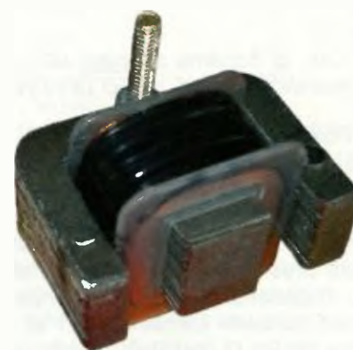
Obr. 2. Navinutá polovina nabíjecího transformátoru
