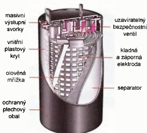
Obr. 1. Konstrukce článku Cyclon
