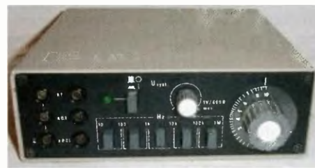
Obr. 10. Schéma a fotografie oscilátoru generátoru BK124
