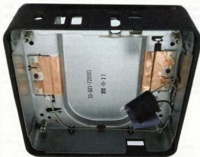
Prázdná skříňka počítače s připravenými anténami
