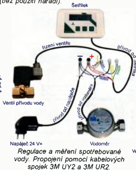
Regulace a měření spotřebované vody. Propojení vodoměru, napájecího zdroje, ventilu pro vodu (se solenoidem) a Šetřilky pomocí konektorů (bez použití nářadí) - přímé řízení ventilu.
