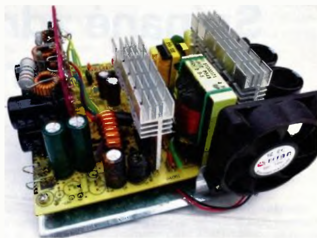
Obr. 31 Hotový zdroj s pomocnou deskou a ventilátorem
