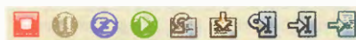
Obr. 13. Tlačítka pro ladění projektu, která se zobrazí při přepnutí do módu ladění v horní části pracovní plochy
