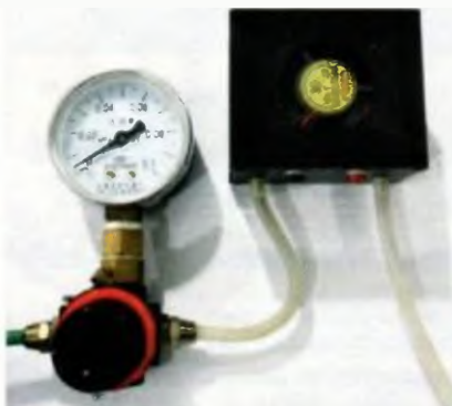
Palivový článek H-12 firmy Horizon Fuel Cell Technologies a jeho připojení ke zdroji vodíku
