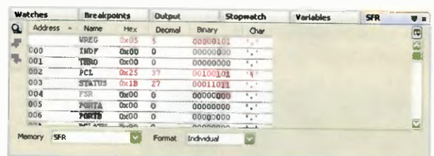
Obr. 17. Okno pro zobrazení aktuálního stavu paměti. V levém dolním rohu lze vybrat mezi datovou pamětí (seznam všech registrů), programovou pamětí, speciálními funkčními registry (na obrázku), konfiguračními bity, hardwarovým zásobníkem a User ID. Červeně zvýrazněné hodnoty byly při ladění programu aktualizovány v předchozím kroku
