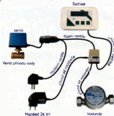
Regulace a měření spotřebované vody. Propojení vodoměru, napájecího zdroje, ventilu pro vodu (se servem) a Šetřilky pomocí konektorů (bez použití nářadí).
