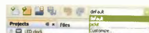
Obr. 5. Mezi jednotlivými konfiguracemi projektu lze snadno přepínat přímo z hlavní nástrojové lišty
