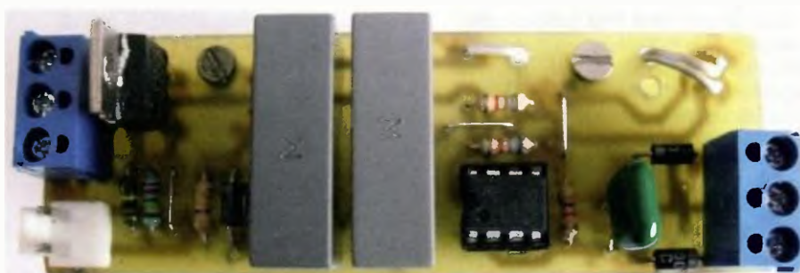
Obr. 7. Osazená hlavní deska
