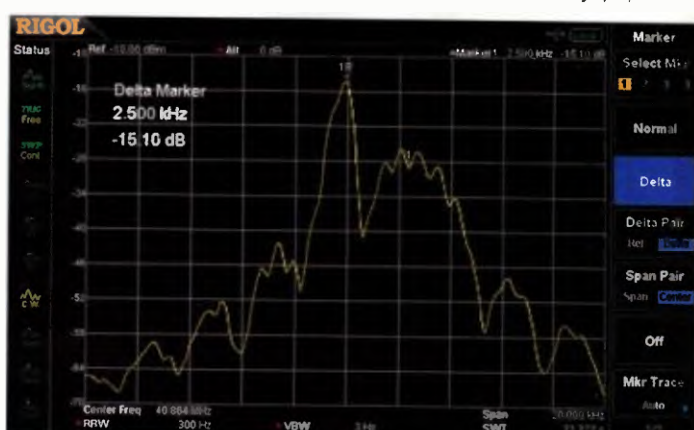
Obr. 23. Zdvih FM modulace modelářského vysílače v detailu
