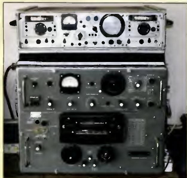
Obr. 1 Sovětský přijímač R-250M2, kterých bylo v letech 1966–1980 vyrobeno asi 10 000 kusů. Celá série RX R-250 od roku 1949 představovala asi 30 000 vyrobených kusů (vlevo)
