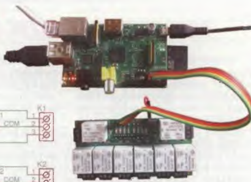
Deska s relé připojená k miniaturnímu počítači Raspberry Pi
