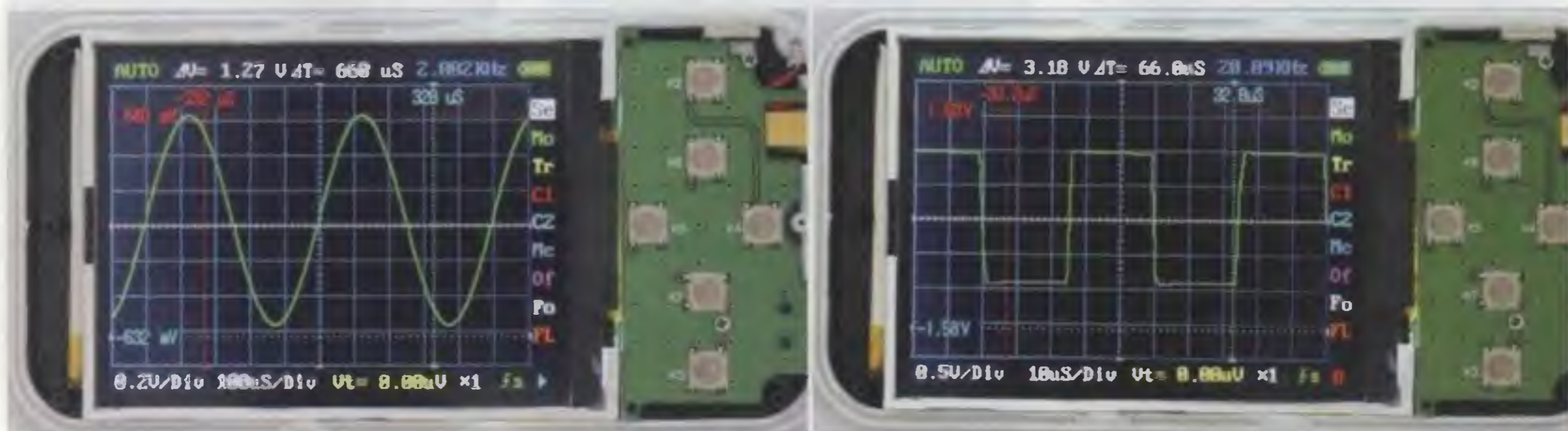
Obr. 10. Ukázka měřených průběhů (sinusový 2 kHz, obdélníkový 20 kHz) na DS0201 se sundaným krytem
