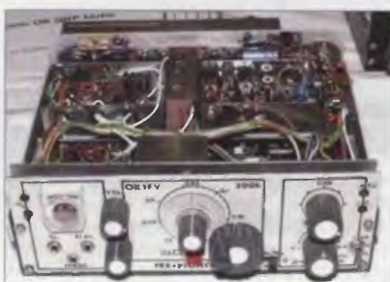
Obr. 5. Tento přístroj vám možná bude připadat trochu povědomý. Původně to byl KV přijímač Pionýr, který na konci 70. let minulého století vyráběl podnik Radiotechnika Svazarmu. Vašek, OK1FV, a Libor, OK1FPL, ho o řadu let později doplnili o 10W vysílač a dali tak vzniknout transceiveru stejného jména. Byl k vidění ve stánku OK QRP klubu
