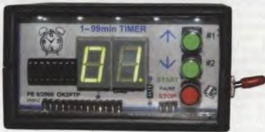
Obr. 3. Přední panel vsazený do krabičky. Do žlábků určených pro zasazení předního panelu je umístěn ochranný panel z organického skla
