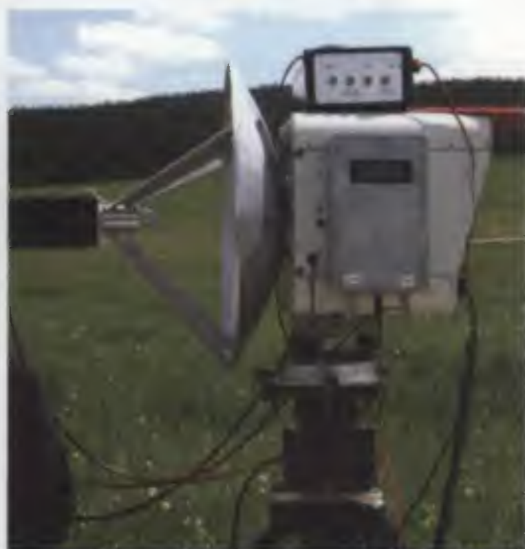
Obr. 3. Sestava OE3WOG pro pásmo 76 a 122 GHz. Přechod na jiné pásmo spočívá jen v záměně transvertoru v ohnisku
