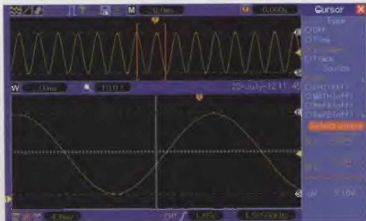
Obr. 29. Průběh signálu na výstupu generátoru DDS
