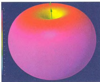
Obr. 7. Trojrozměrné zobrazení vyzářovacího diagramu Alfordovy smyčky pro signály s horizontální polarizací
