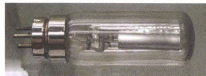
Obr. 9. Dioda, kterou používal August Žáček při svých pokusech jako magnetron. Katoda je přímý drát, anoda je váleček svinutý kolem katody. Vyrobená v továrně Elektra Hloubětín r. 1924
