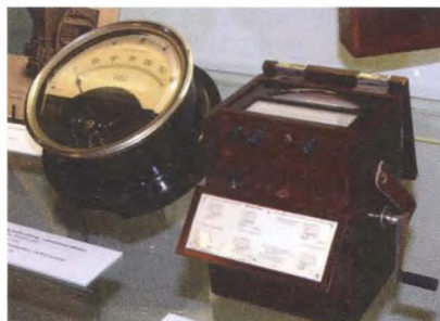
Obr. 8. Elektrické měřicí přístroje Ericha Roučky. Vlevo rozvaděčový voltmetr z r. 1913, vpravo měřič izolace z r. 1930
