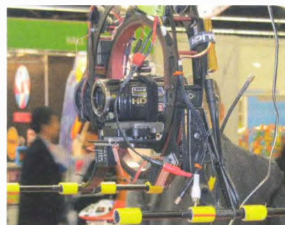
Obr. 1. Závěs vrtulníku s nastavitelnou a stabilizovanou kamerou - množství použité elektroniky nezapře na první pohled
