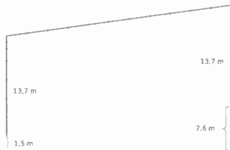
Obr. 21. Šikmo postavená anténa Half-Square nebude fungovat. Výškový rozdíl 6 m mezi konci stáči na to, aby se ztratil nízký vyzářovací úhel
