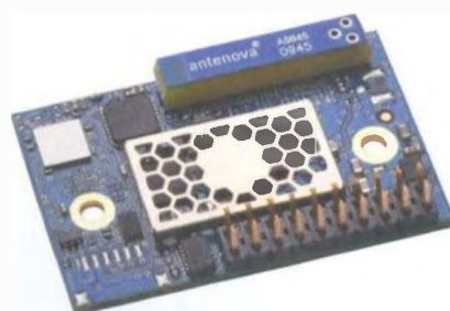
Obr. 4. Bluetooth modul connectBlue OBS433 s dosahem přes 1000 m
