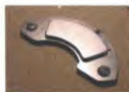
Obr. 7. Připevnění vysílače pomocí magnetu
