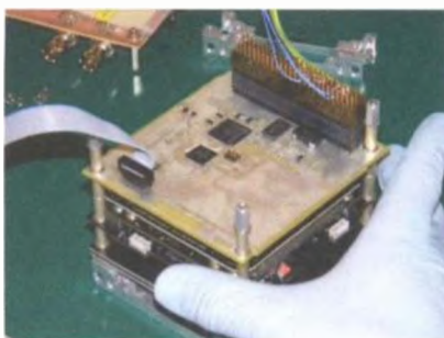
Rozpracovaný prototyp satelitu FUNcube
