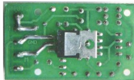
Obr. 3. Zadní strana desky s tranzistorem MOSFET a zesílenými vývody
