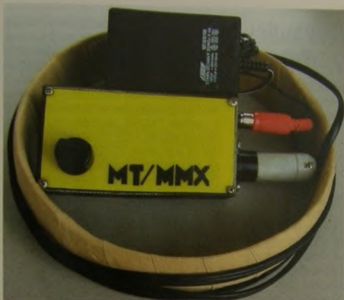
Obr. 3. Pohled na kompletní zařízení pro MT. V aplikační cílce o průměru 16 cm leží upravený síťový adaptér s výstupním napětím 14 V a generátor impulsů MT/MMX
