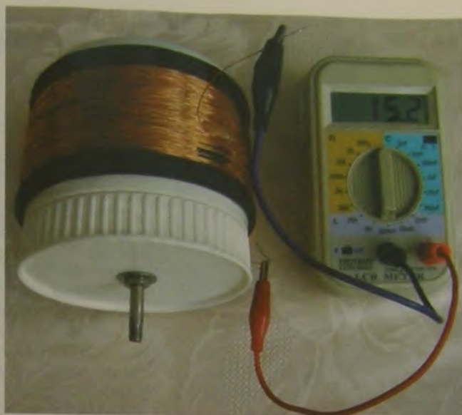
Obr. 6. Způsob vinutí aplikační cílky o vnitřním průměru 96 mm. K cílce je připojen měřič indukčnosti, na kterém lze odečíst její indukčnost 15,2 mH
