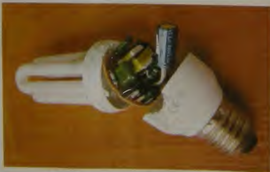
Obr. 2 Rozlousknutá zářivka PHILIPS GENIE 14W
