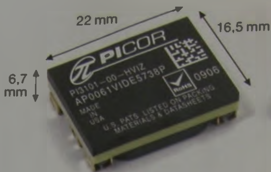
Obr. 1. Izolované DC-DC měniče Cool-Power™ s výkonovou hustotou 25 W/cm 3 (vstup 36 až 75 V, výstup 3,3 V/18 A, 60 W)
