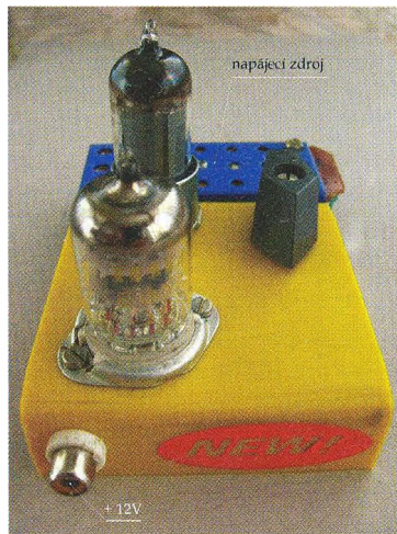
Obr. 11. Realizovaný elektronkový oscilátor s keramickým rezonátorem. V modrém modulu je impulsní zdroj anodového napětí
