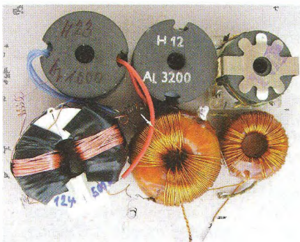
Obr. 5. Různá provedení výstupního transformátoru TR1 impulsního zdroje
