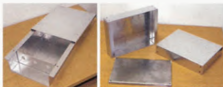
Obr. 3. Univerzální skříňka pro anténní relé k VKV a UKV směrovkám a pro nostalgiky univerzální šasi pro experimentování s elektronikami
