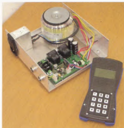
Obr. 5. Řídicí elektronika a ovladač rotátora RAK SPID
