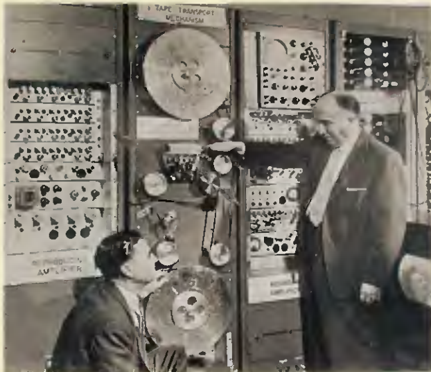
Obr. 15. První záznamové zařízení obrazu a zvuku RCA z roku 1953
