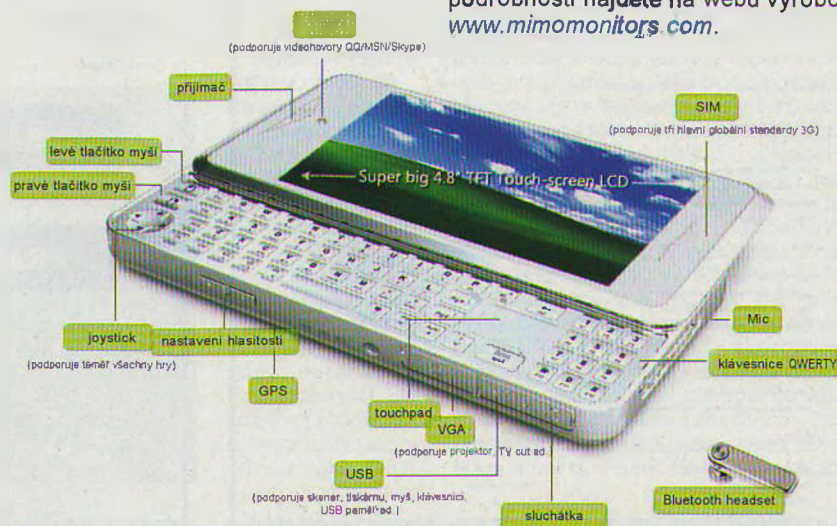
Vybavení mobilního telefonu xpPhone s operačním systémem Windows XP
