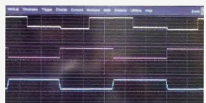
Obr. 5d. Upravené signály při dalším snížení otáček disku
