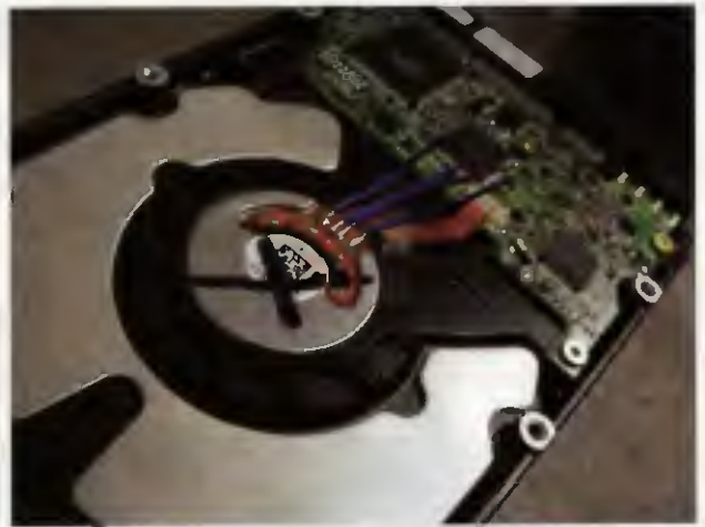
Obr. 1. V rozebraném pevném disku je nutné najít vývody motorku a připájet k nim dostatečně dlouhé přívody
