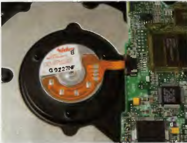
Obr. 1. V rozebraném pevném disku je nutné najít vývody motorku a připájet k nim dostatečně dlouhé přívody
