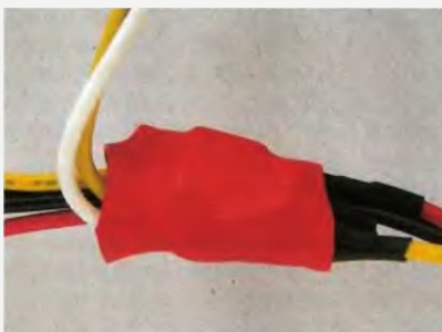
Obr. 3. Spínač v bužírce
