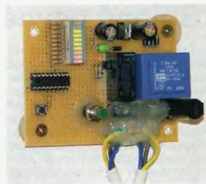
Obr. 2. Časovač na univerzálnej doske
