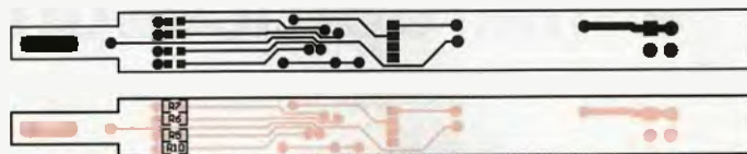
Obr. 6. Spodná strana dosky a osadenie
