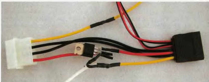
Obr. 2. Přívodní vodiče 5 V (červený) a 12 V (žlutý) přerušíme a zapojíme spínač
