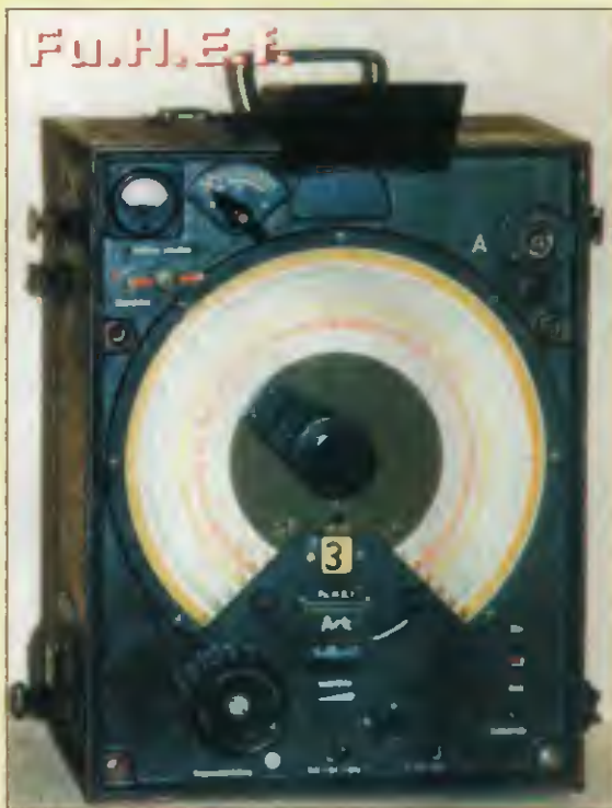
Obr. 6. Vývoj odposlechového přijímače pro VKV typu FuHE.f stál zá- vratnou částku 650 tisíc RM, dnes je velice vyhledávaný sběrateli vojenské techniky druhé světové války (vlevo)
