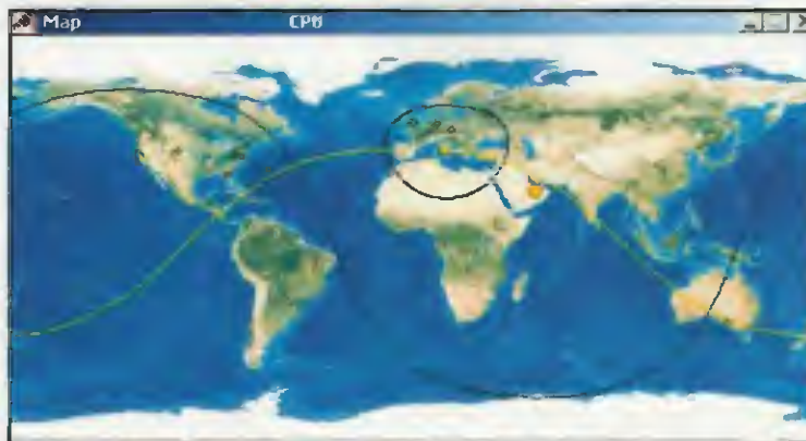
Obr. 2. Zobrazení dráhy CubeSatů s inklinací 40°
