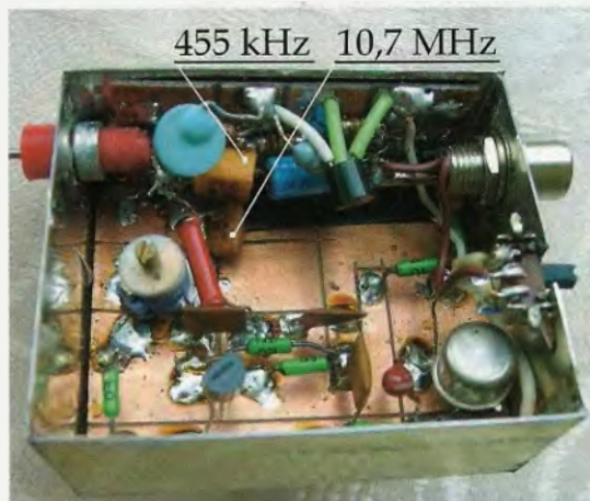
Obr. 2. Vnitřní uspořádání vylepšeného FM generátoru. Vlevo nahoře je zdička s výstupním hrotem
