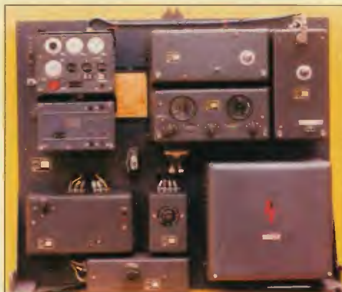
Obr. 7. Testovací pult vysilací a řídicí jednotky pro kluzákovou pumu Fritz X
