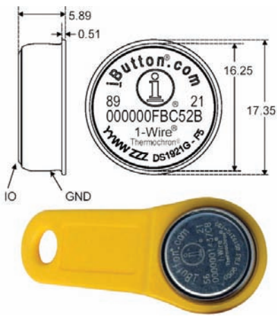
Obr. 3. Rozměry a provedení ThermoChronu
