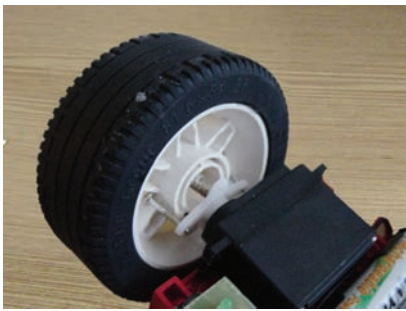
Obr. 16. Detail připevnění kola
