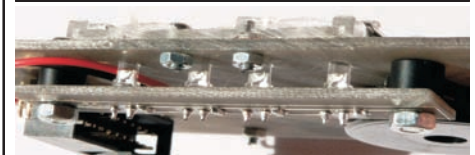
Obr. 5. Deska s plošnými spoji diod LED a jejich montáž
