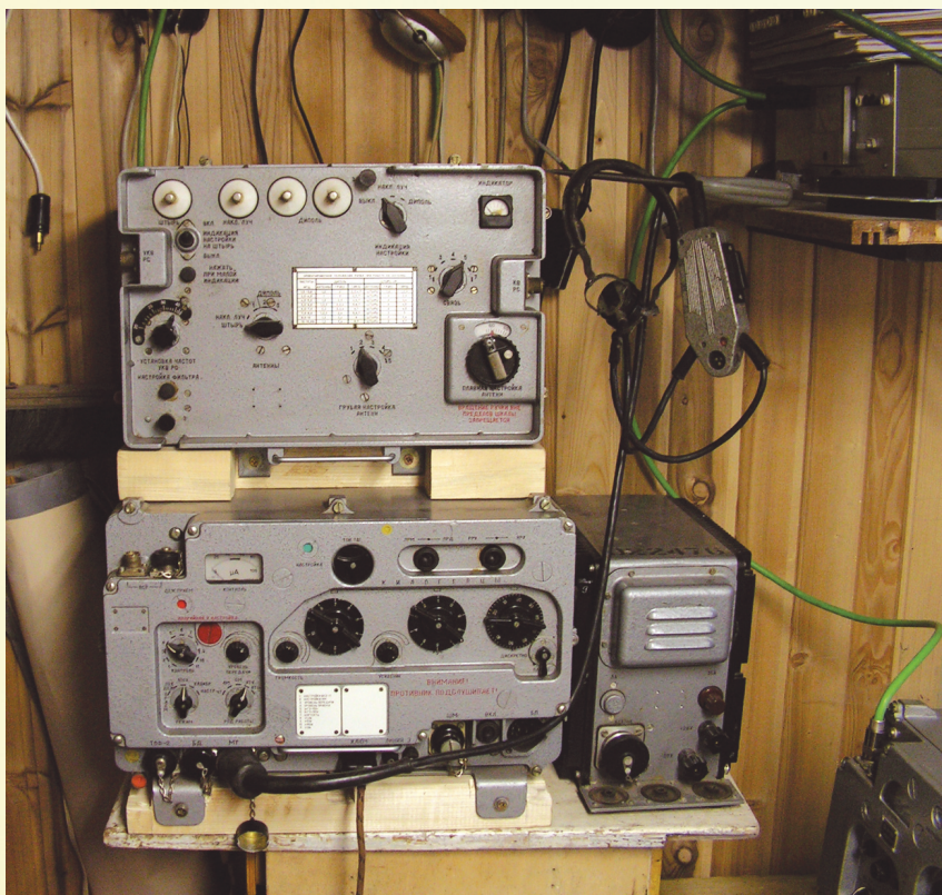
Obr. 1. Pohľad na celkovú zostavu sovietskej rádiostanice R130. Kmitočtový plán vychádza z kryštálového oscilátora 2 MHz umiestneného v termostate a delením a násobením sa získava potrebné kmitočtové spektrum od 1,5 MHz po 10,990 MHz, pričom nedostatkom je „diera“ 10 kHz v každej stovke od 90 kHz po 100 kHz. Má aj plynulé nastavenie kmitočtu. Vie A3, A3j, A1, F1. Citlivosť udáva manuál lepšiu ako 3 \mu V pre odstup signál/šum 10 dB a výstupný výkon 40 W. Má automatiku na naladenie na výstupnú impedanciu 75 \Omega . SSB signál je generovaný na kmitočte 40 kHz 6obvodovým LC filtrom a pri dôslednom vybalancovaní sa dá dosiahnuť potlačenie nosnej 40 dB, pričom treba podotknúť, že rádiostanica je pôvodne nastavená na určitú úroveň nosnej. Manuál udáva 3 až 20 % maximálneho výstupného signálu
