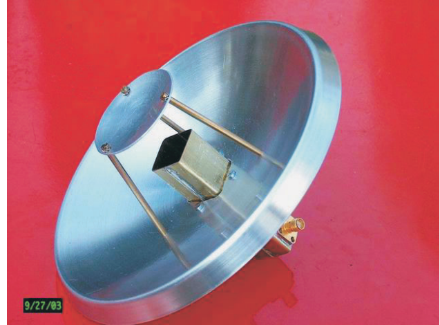
Obr. 3. Prototyp antény družice Phase 3E pro pásmo 10 GHz
