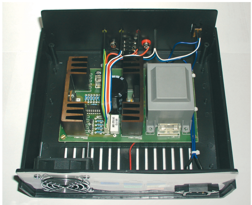
Obr. 10. Fotografie vnitřního uspořádání nabíječky
