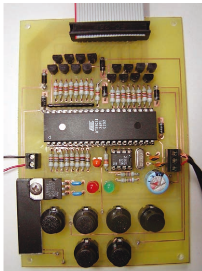
Obr. 12. Osazená deska procesoru
