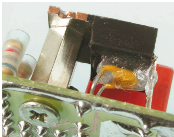
Použití polymerové pojistky jako snímače teploty v regulátoru BEL AL16A
