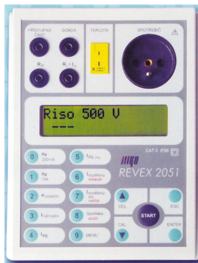
Přístroj pro revize a kontroly REVEX 2051
