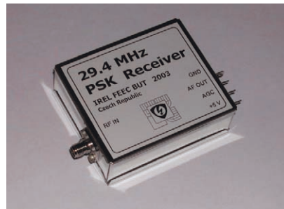
Obr. 2 a 3. Pohled na hotový přijímač pro transpondér PSK31
