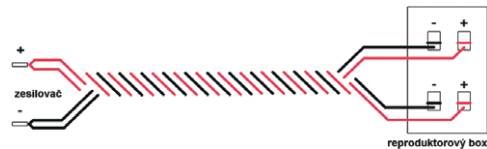
Obr. 13. Základní zapojení krouceného kabelu Bi-Wiring
