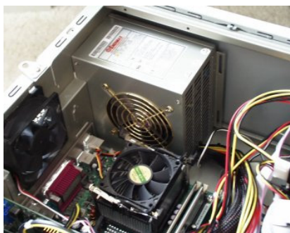
Obr. 2. Větší ventilátor nasává teplý vzduch z okolí procesoru
