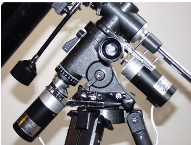
Obr. 16. Celkový pohled na montáž GS 300 hvězdářského dalekohledu, vybavenou na osách Ra i Dec rotačními inkrementálními snímači české produkce typu IRC 122 snímajícími polohu dalekohledu s rozlišením 10 000 dílků/360°. Spolu s modulem NAVIGATOR-1 a programem SkyCharts instalovaným v PC tvoří ucelený systém ulehčující orientaci a pointaci objektů na nebeské obloze
