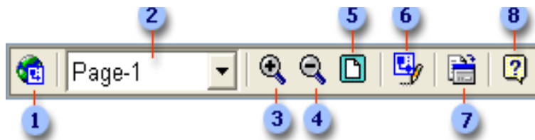
Nástrojový pruh webového komponentu Visio v Internet Exploreru: 1 - O aplikaci, 2 - výběr stránky výkresu, 3 - zvětšování, 4 - zmenšování, 5 - celá stránka, 6 - otevření obrázku v editoru Visio (je-li nainstalován), 7 - vlastnosti objektů/zobrazení, 8 - Help
