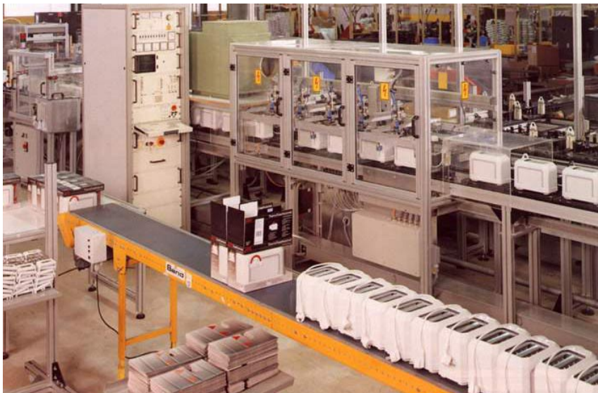
Obr. 1. Plně automatický testovací systém pro kontrolu toasterů
