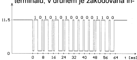
Obr. 2. Kódování datového přenosu mezi ústřednou a terminálem
