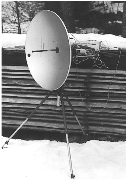
Pavel Šír, OK1AIY, se zařízením pro 24 GHz mezi svými anténami. Vlevo antény pro pásma 70 cm - 21EL F9FT, 23 cm - 4x 25EL loop Yagi, 13 cm - 4x 25EL loop Yagi. Vpravo parabolická anténa pro pásmo 24 GHz. Snímky z roku 1989
