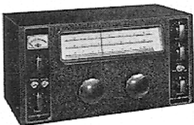
12lampový superhet NC-100 s rozsahem od 30 MHz do 540 KHz; frekvenční rozsahy se měnily obdobně jako u německého přijímače Hamzl; nazval bych to jakýmsi „podélným karuselem“
