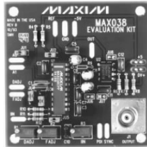
Vývojový kit generátoru s obvodem MAX038
