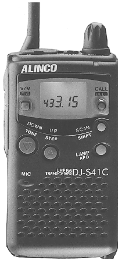
Obr. 1. Pohled na čelní stranu transceiveru ALINCO DJ-S41; hmotnost 185 g, rozměry: 100 x 55 x 28 mm
