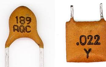
Obr. 4. Kondenzátor s kapacitou 1,8 pF ( 18 \times 0,1 ) a 0,022 \mu F = 22 nF
