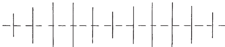
Obr. 5. Schéma dielektrické antény se dvěma doutníkovými sekcemi
