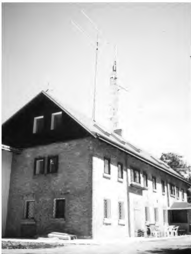
Stanoviště Mirka Semeráda, OK1VMS: kóta Jedlová, JO70GU, nadmořská výška 774 m. Anténa Yagi podle DJ9BV, předzesilovače osazeny CF300
