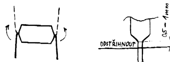
Obr. 8. Způsob úpravy vývodů integrovaných obvodů pro otáčkoměr varianty B
