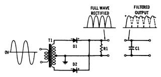
Fig. 2-4. Full-wave rectifier.
