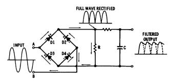
Fig. 2-5. Bridge rectifier.
