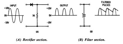
Fig. 2-3. Diode rectifier and filter.
