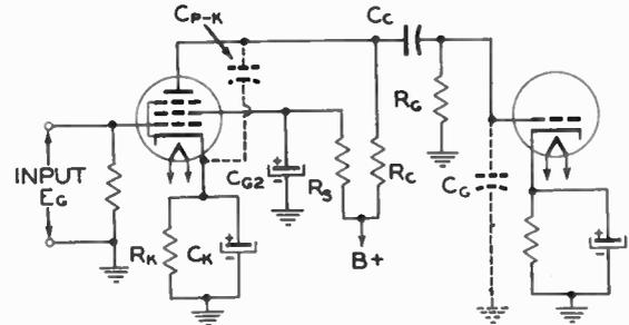
A. TYPICAL RESISTANCE COUPLED AUDIO AMPLIFIER STAGE
