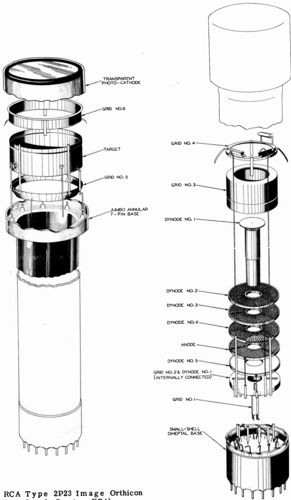
**Fig. 25. RCA Type 2P23 Image Orthicon**
