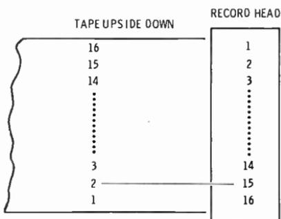
15 IS SECOND TRACK FROM THE BOTTOM OF THE RECORD HEAD
