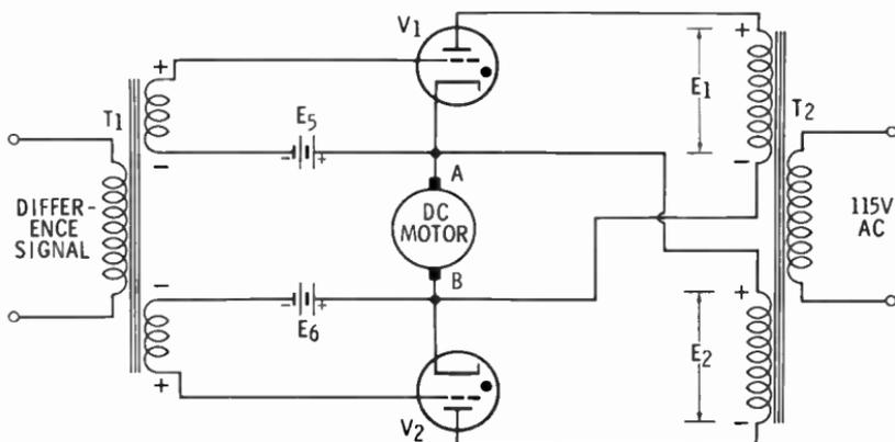
**A BIDIRECTIONAL THYRATRON DC SERVO AMPLIFIER**
