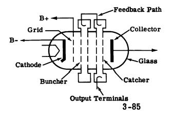
SCHEMATIC Of Klystron
