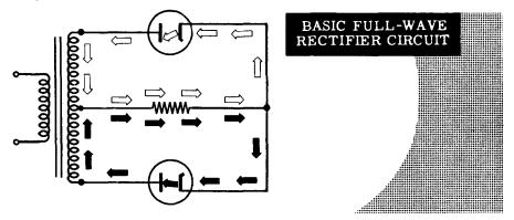
TYPICAL COMPLETE FULL-WAVE RECTIFIER CIRCUIT
