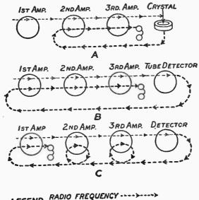
FIG. 87.—GRAPHIC COMPARISON OF THE PRINCIPLES OF OPERATION OF REFLEX CIRCUITS AND THE INVERSE DUPLEX CIRCUITS.
