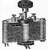
Fig. 24.—A 23-plate variable condenser.
