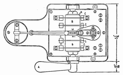
Fig. 33 .- Top View Antenna Switch.
