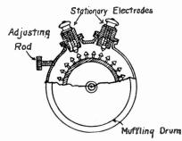
Fig. 23.-Synchronous Rotary Gap.
