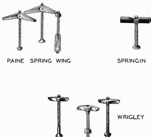
Fig. 102. Winged Toggle Bolt.
